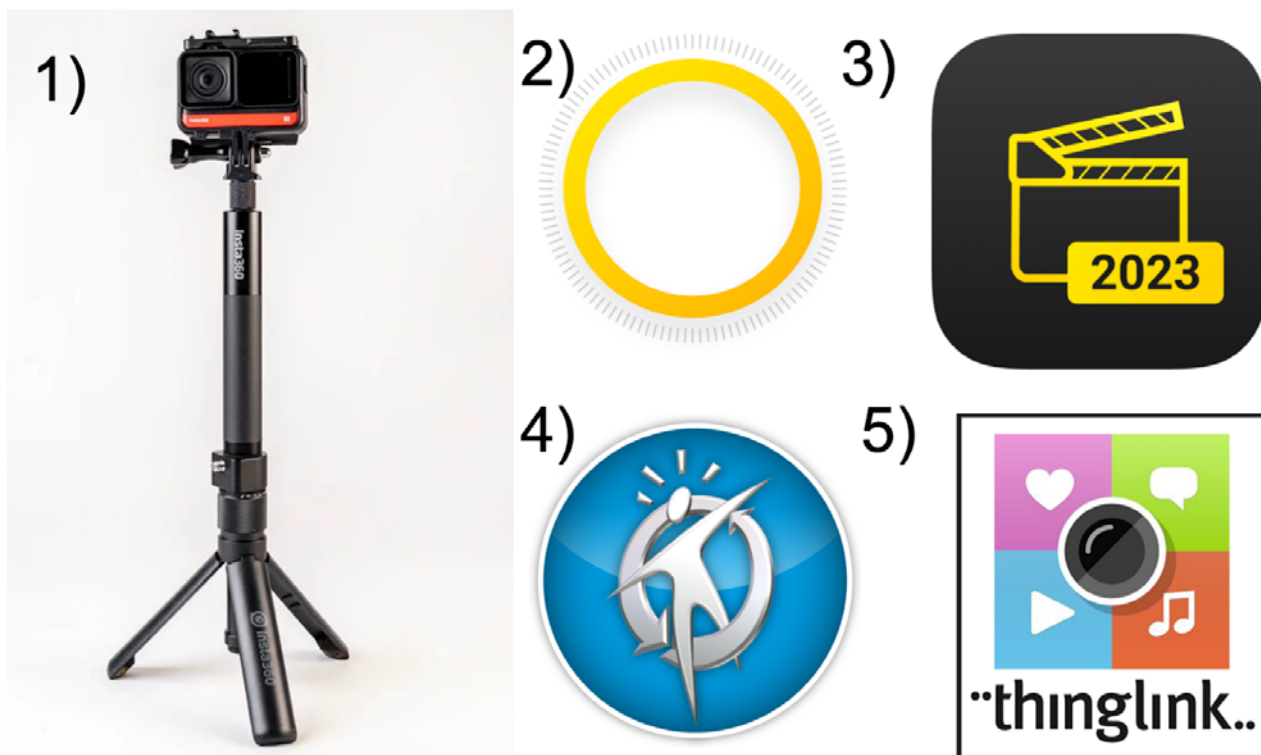
Ryc. 6. Sprzęt do tworzenia wycieczek 360: 1) Insta360 ONE R na statywie; 2) aplikacja mobilna Insta360 do robienia zdjęć 360; 3) oprogramowanie Insta360 Studio przenoszące zdjęcia 360 na komputer; 4) profesjonalne oprogramowanie 3D Vista do tworzenia wycieczek 360; 5) bezpłatne oprogramowanie ThingLink do tworzenia wycieczek 360
